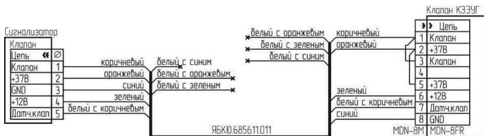
Рисунок Б.5 – Схема подключения клапана КЗЭУГ с разъемом MDN8FR.
