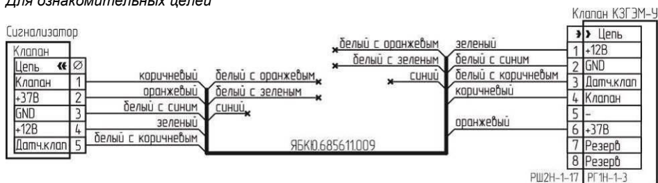
Рисунок Б.3 – Схема подключения клапана КЗГЭМ-У с разъемом РГ1Н-1-3.
