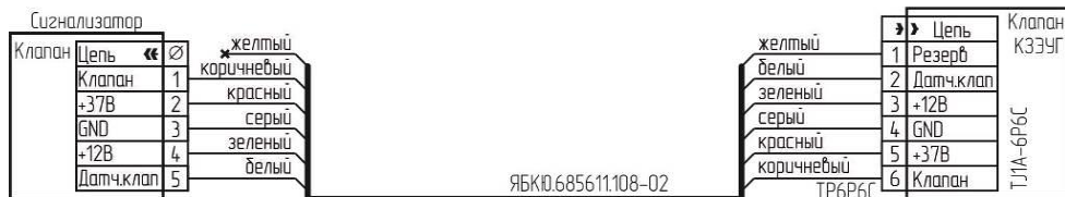
Рисунок Б.6 – Схема подключения клапана КЗЭУГ с разъемом Т1А-6Р6С.
