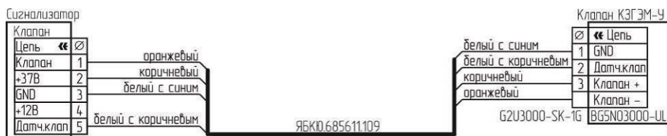
Рисунок Б.4 – Схема подключения клапана КЗГЭМ-У с разъемом BG5N03000-UL.
